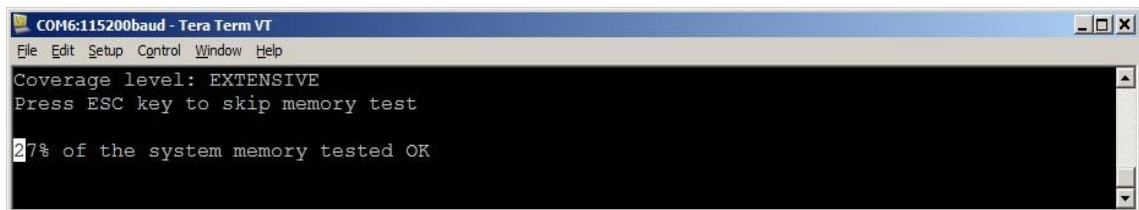
Bild 6: Speichertest während des Boot-Up
