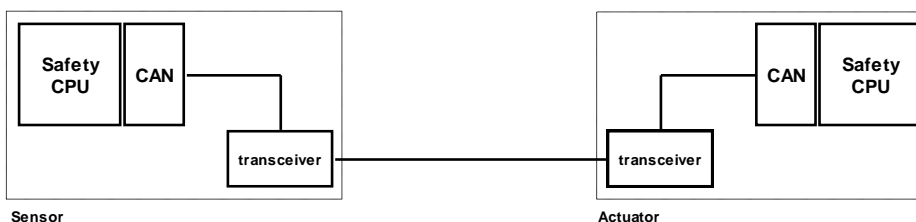
Abbildung 5: einkanlige Hardware mit einer Safety-CPU
